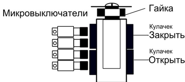
Рис. 8а Настройка конечных выключателей приводов САТУРН ЭП-Ч 003-015
